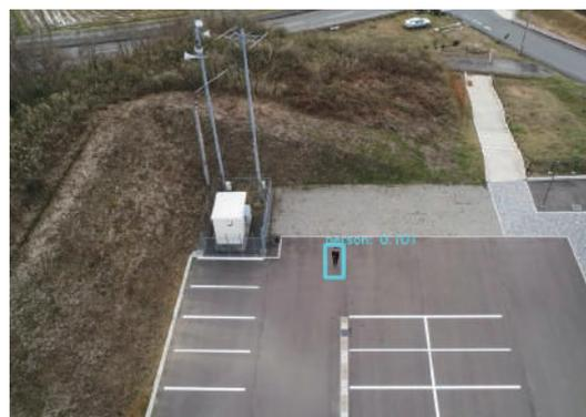
図2：ドローン空撮画像から機械学習により人検出をした例
