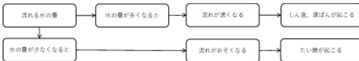
流れを早くするには，「土地のかたむきを大きくすること」と「水の量を多くすること」があります。台風などの大雨が降ると，水の量が多くなり，かたむきが大きい山の中では流れが非常に速くなります。流れた小石や砂によって，岩や石が，けずられたり，運ばれます。
