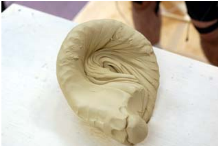
図 3.3 菊練り動作によって作り出される粘土のパターン
