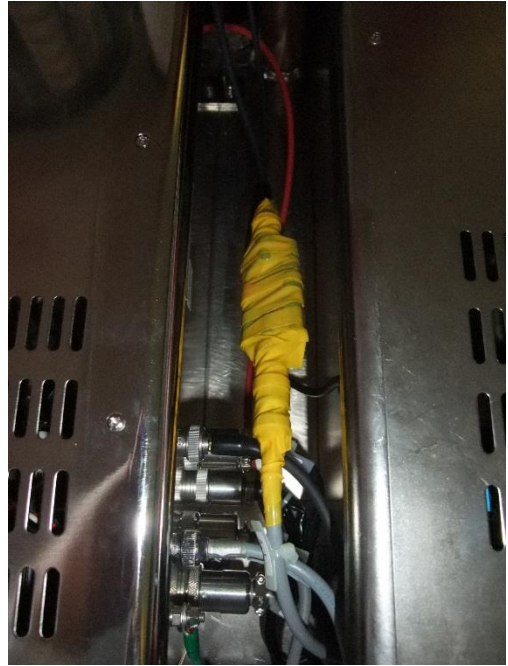
図 6. (右) 絶縁対策として目立つ黄色のビニールテープでぐるぐる巻きにしたバナナソケットターミナル部。正負を逆にする仕組みが絶縁面でとても心配である。本装置は 2 段階の加速器を持ち（詳しくは昨年の報告書を参照）、それに伴って 2 段階の絶縁が用意されている。このアーク電源は最上流部の電位に入るため、同電位の箱の中に格納しておいた。図 5 は逆転回路の試験をしたときの写真であり、そのまま高電圧を掛けると次の段の異なる電位と短絡する恐れがあるため、このようになった。
