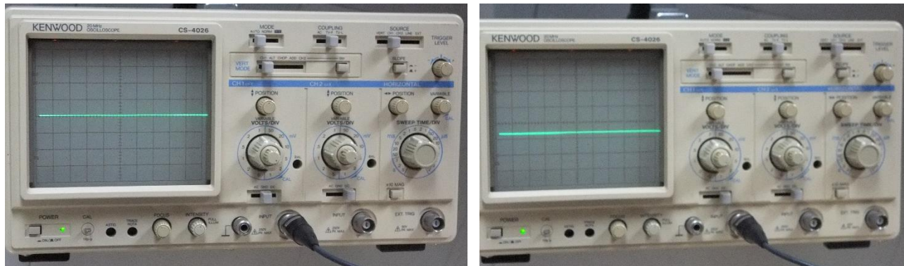
図 4. オシロスコープを用いて BNC ケーブルを調べている図。(左) アーク電源を入れる前。0V になっているため中央の線と重なっている。(右) アーク電源投入後、マイナスに振れているため下側に線があるところに注目。
