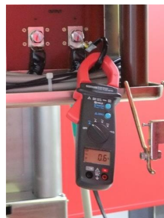
図3. (左) アーク電源の箱。左が電圧計で右が電流計である。 (右) テスト用に繋いだクランプメータ。直流で0.6Aを表示している。
