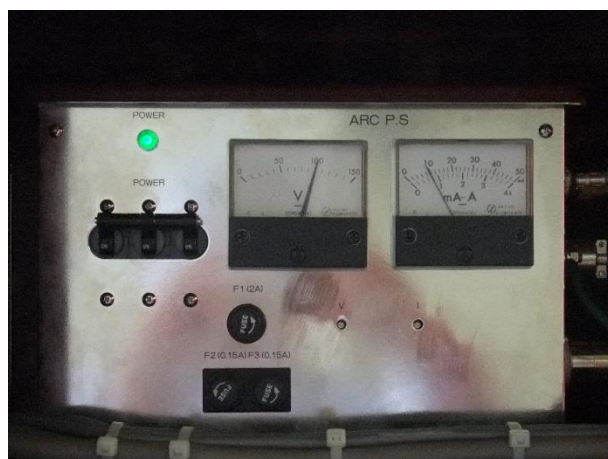
図3. (左) アーク電源の箱。左が電圧計で右が電流計である。 (右) テスト用に繋いだクランプメータ。直流で0.6Aを表示している。
