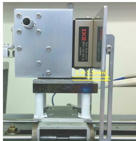
図3：LSM方式ミスト混合・製膜ユニット（左：概略図、右：作製したユニット）
