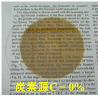
図3 アモルファス SiC 薄膜 (膜厚 100 nm 程度) (左) と光学バンドギャップ測定の結果 (右)
