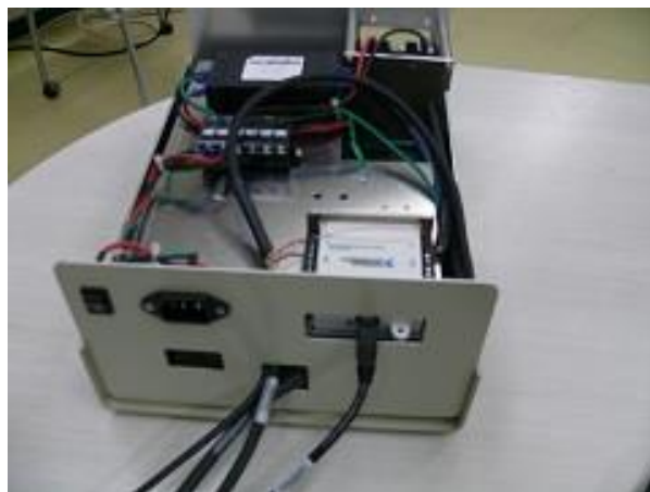
図 2. 制御ボックス内部
